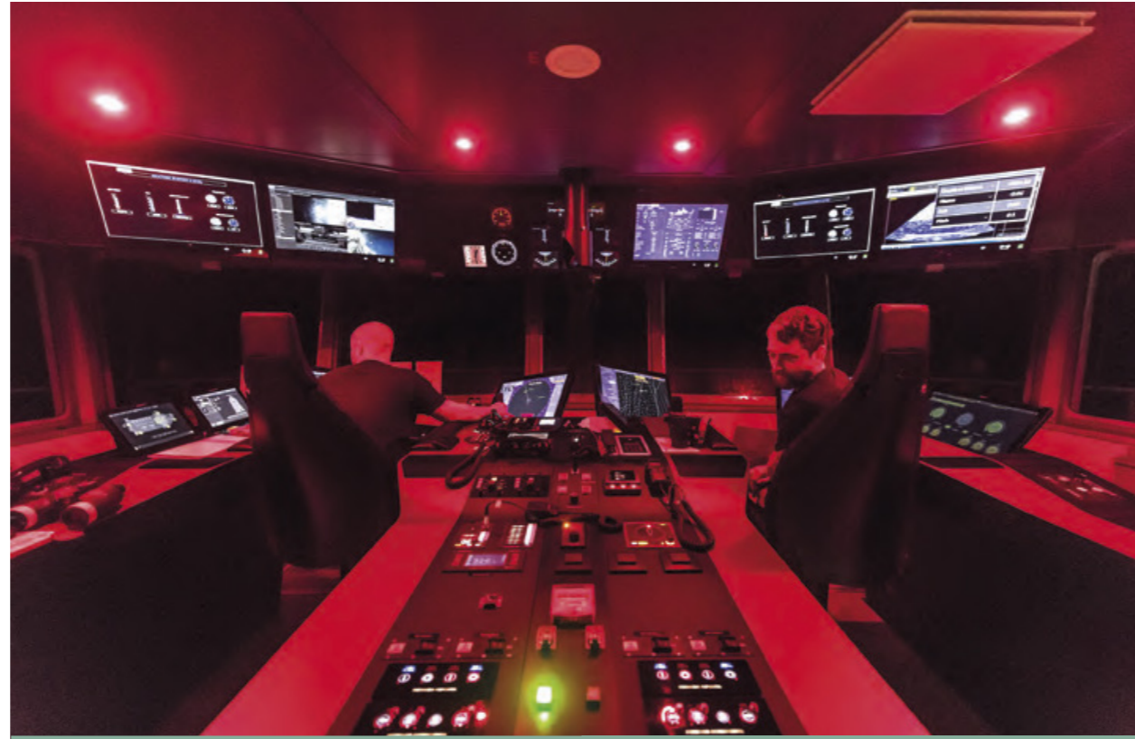
De Belgica is uitgerust met satelliettechnologie waarmee het tot op de meter nauwkeurig positie kan houden, zelfs in moeilijke weersomstandigheden.
